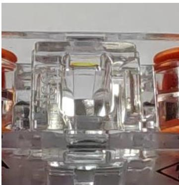
Die Arretierungsblöcke im Deckel sind so dimensioniert, dass sie in die Prüföffnung der Wago Klemmen passen und diese entsprechend an der Grundplatte fixieren.
