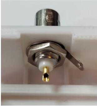
Als nächstes wird der Anschlussring mit der Lötflamme für den Masseanschluss, die Zahnscheibe (sofern vorhanden) und die Kontermutter aufgeschraubt.
